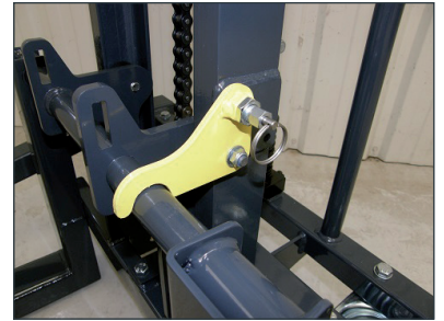
Dispositif de blocage du tablier, pour sécuriser les déplacements en véhicule
