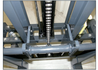
Tablier mobile robuste, guidé par 4 roulements à billes surmoulés
