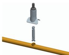
Oter l'outil du porte outil extrudeur, en ramenant la vis de ce dernier en position avant (sens horaire).
