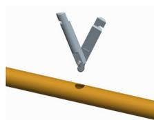
Introduire l'outil à extruder dans le trou, en ayant au préalable enduit sa tête de lubrifiant PED.
