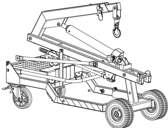
Afin de faciliter le transport et l'installation sur chantier, les principaux éléments de la machine sont pliables.
