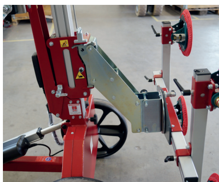
Le prolongement oblique vers le bas permet de recevoir des disques étroits
