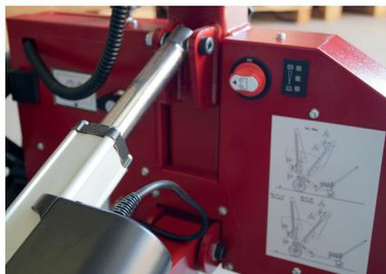
Basculement électrique du bras de grue de +7° et -30° pour un transport optimal et un montage facile.
