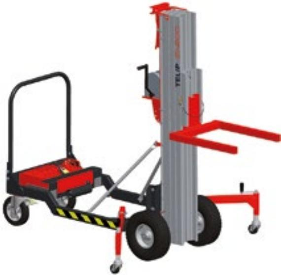
Le centre de gravité de la charge doit être situé à 400 mm maximum de la face avant du mât central.
