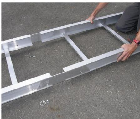
Le système d'éclissage à rampe d'emboîtement permet d'assembler très facilement les éléments. Les axes d'assemblage sont également très rapidement montés grâce au système de goupille et restent toujours libres.
